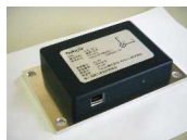
加速度計 KTN-3G-1 自社製品
